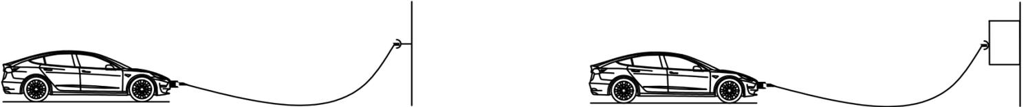
*Conexión de un VE al cargador utilizando un cable de carga extraíble, equipado en un extremo con ficha (para conexión al SAVE) y en el otro extremo con conector (para conexión al VE).*
