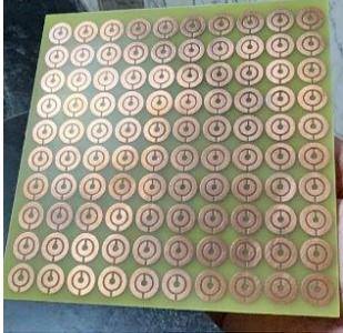
Fig. 9. Placa de metamaterial
