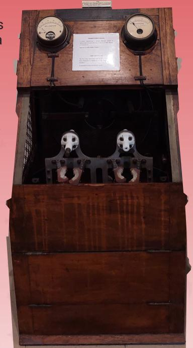
**Primer transmisor a válvula, realizado en La Spezia en el año 1920. Operaba en Onda Larga y Onda Media. Su matrícula es la N1.**
