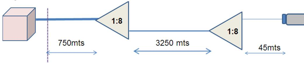
En este ejemplo se da la misma red pero con empalmes en lugar de conectores de entrada y salida en las cajas que contienen los divisores ópticos.
