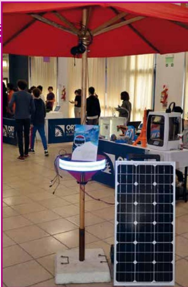
La sombrilla está conectada a un panel solar que alimenta una batería y que sirve para cargar dispositivos electrónicos.
