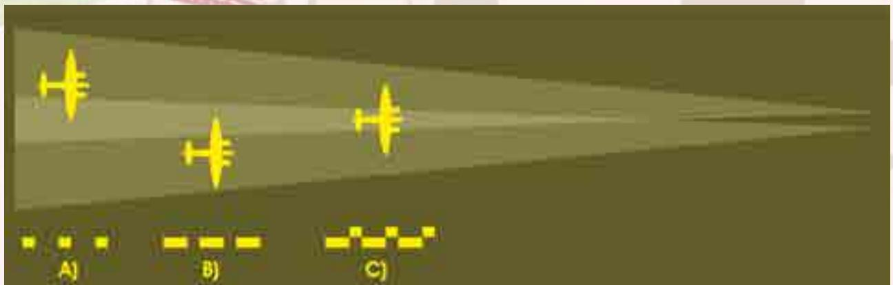
FIGURA 1: Esquema del LFF A) avión a la izquierda, se oyen “puntos”, B) avión a la derecha, se oyen “rayas”, C) señal continua que indica alineación con el eje de la pista.
